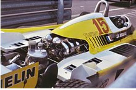
Le moteur turbocompressé équipant Renault, qui va devenir l'objet de toutes les convoitises.
