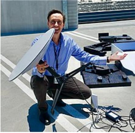
Le terminal utilisateur dans sa version commercialisée au début du déploiement de Starlink.
