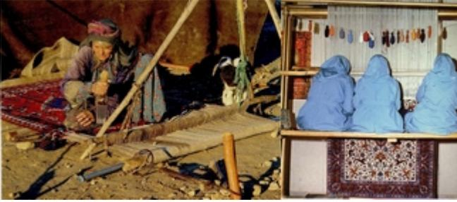
Les tapis sont réalisés sur un métier, (cadre) sur lequel on tend des fils de coton, ou de laine, ou de soie. (Chaîne).
